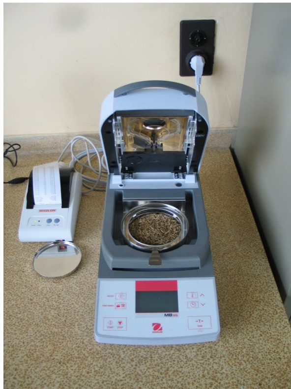
Foto 2: vochtmeter infrarood-toestel OHAUS MB35 – 130 °C-35 min-10 g
